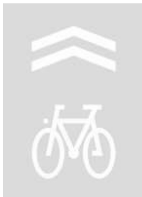
Slika 1: Horizontalna oznaka -upozorenje vozačima: Biciklisti na kolovozu
